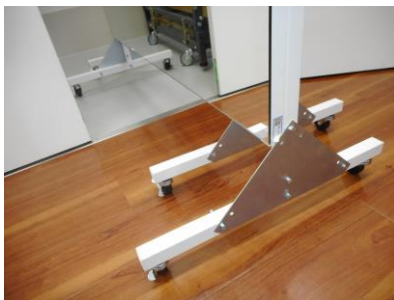
大鏡の補強修理
